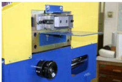
Станок имеет автоматическую систему управления, старт-стоп переключатель, переключатель режимов ручного или автоматического режима работы, расположенные на боковой стороне машины.
